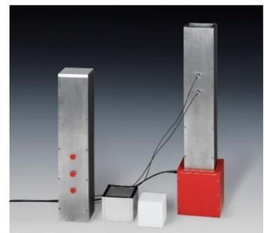
Transmissionsrohr wird hier mit Halb-Zoll-Mikrofonen gemessen.
