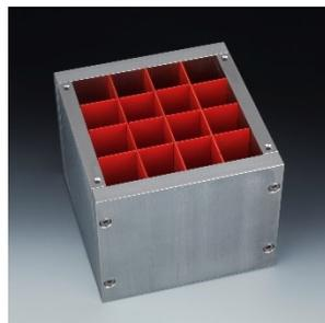
**Abbildung 13:** Segmentierter Probenhalter für das große Transmissionsrohr
