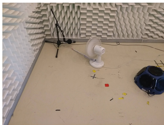
Abbildung 2: Messaufbau für Windabhängigkeit
