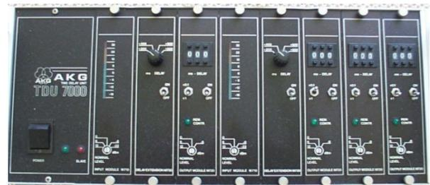
Abbildung 35: Verzögerungsgerät TDU7000 der Fa. AKG
