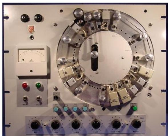
**Abbildung 32:** Nachhallmaschine EL 6911 von Philips
