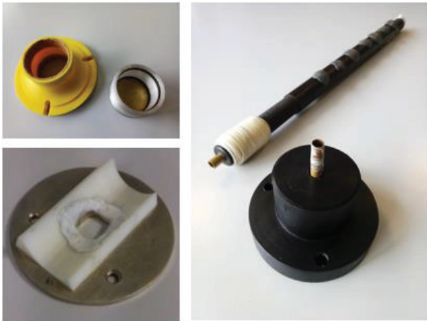
Figure 2 : Pièces d'adaptation utilisées pour mesurer l'impédance du tube de calibration (en haut à gauche), de la flûte traversière (en bas à gauche) et du « chanter » du Uilleann Pipes (à droite).
