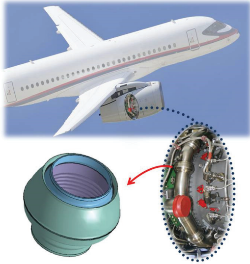
Figure 1: Vue d'ensemble ligne de tuyauterie pneumatique avec rotules intégrées
