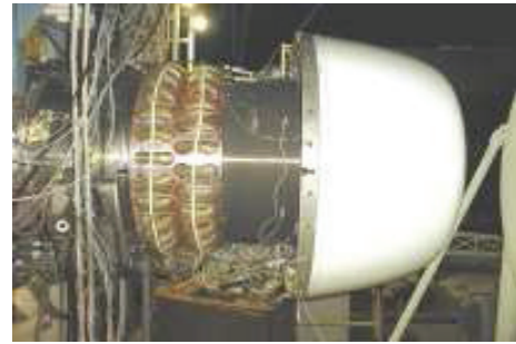
FIGURE 3 – Deux rangées de tubes HQ installés sur moteur (d'après [6]).
