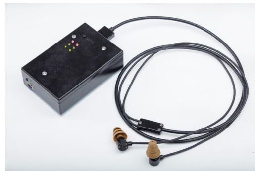
Figure 1: Photographie du prototype électronique de mesure d'étanchéité acoustique.
