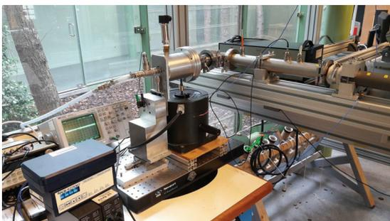
FIGURE 12 – Source électro-pneumatique à fort niveau.
