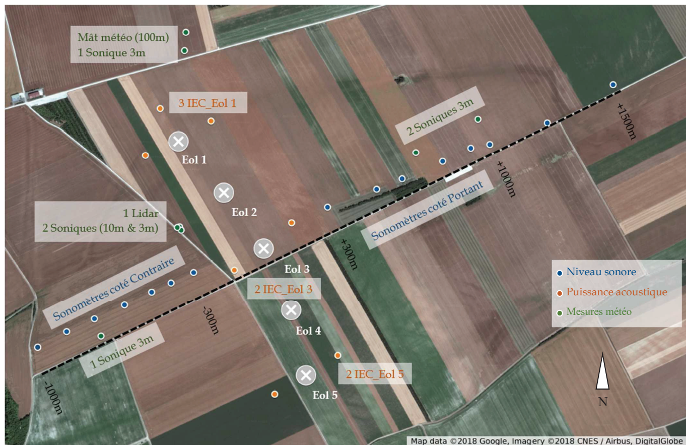
Figure 1: Protocole expérimental de la campagne présentant les différents types de mesures réalisées (niveaux sonores, puissance acoustique, météorologie) et types de capteurs déployés (sonomètres, anémomètres soniques, lidar et mât météo), ainsi que les 5 éoliennes du site (Eol 1-5).
