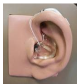
Figure 2: Oreille artificielle du KEMAR  quip e d'un appareil auditif contour d'oreille avec embout ferm .
