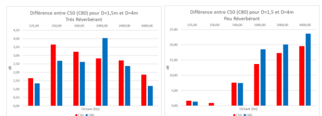
Figure 10 : Comparaison entre C50 (et C80) pour D = 1,5 m et C50 (et C80) pour D = 4 m - Grande Salle - Oreilles non appareillées.
