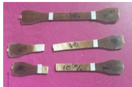
Figure 9 : Eprouvettes PP/FBO avec m_{FBO} = 10\% avant et après l'essai de traction.
