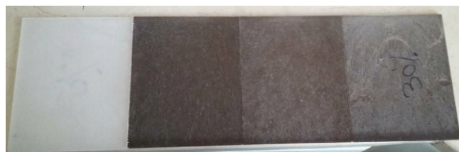
Figure 1 : Plaques de dimensions L \times l \times e_p = 120 \times 100 \times 4 mm 3 de bio-composites PP/FBO avec une fraction massique croissante de FBO de 0 à 30%.
