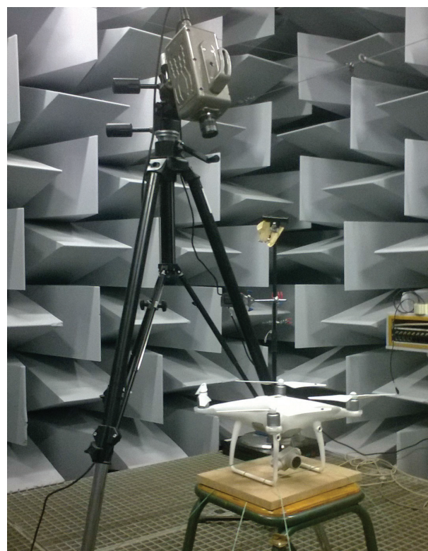
FIGURE 4 – Photo du drone fixé en 8 points d'attaches à l'aide de fils en nylon. La caméra rapide pointée verticalement au-dessus du drone permet de mesurer la vitesse de rotation des hélices.
