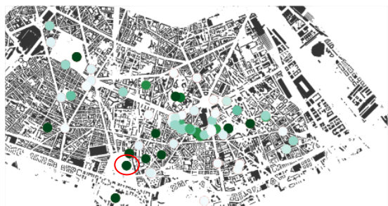
Figure 3. Proportion des cartes produites pour lesquelles le niveau des oiseaux est supérieur au niveau du trafic sur la bande de fréquence centrée sur 4kHz (Echelle linéaire du blanc 0% au vert 100%)
