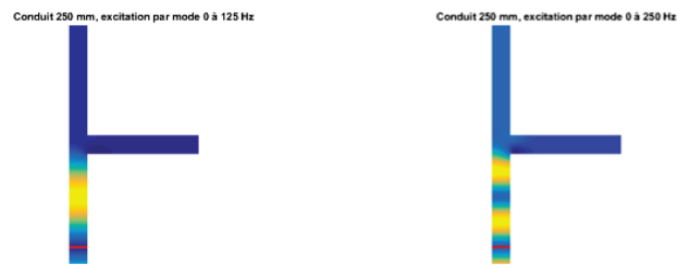
Figure 7: Distribution de pression à 125 Hz et 250 Hz pour une excitation en onde plane dans la branche inférieure (module de la pression).
