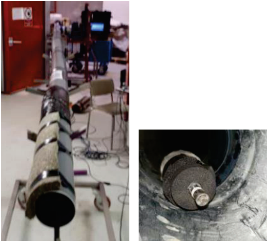
Figure 11: Montage expérimental pour l'évaluation de l'atténuation le long d'un conduit droit.
