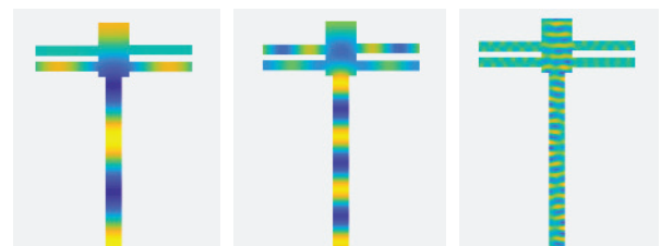
Figure 15: Exemple de répartition du champ de pression acoustique ; de gauche à droite : 200, 400 et 2000 Hz.
