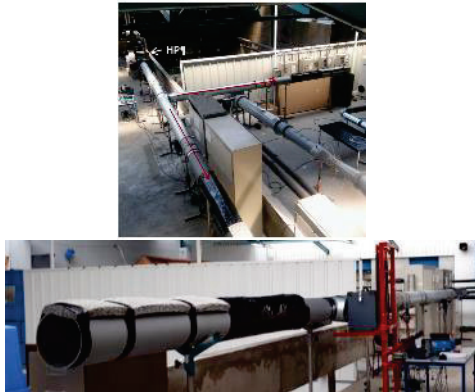
Figure 3: Photos du système expérimental (en haut, HP en bout du conduit amont, et en bas, HP perpendiculaire).
