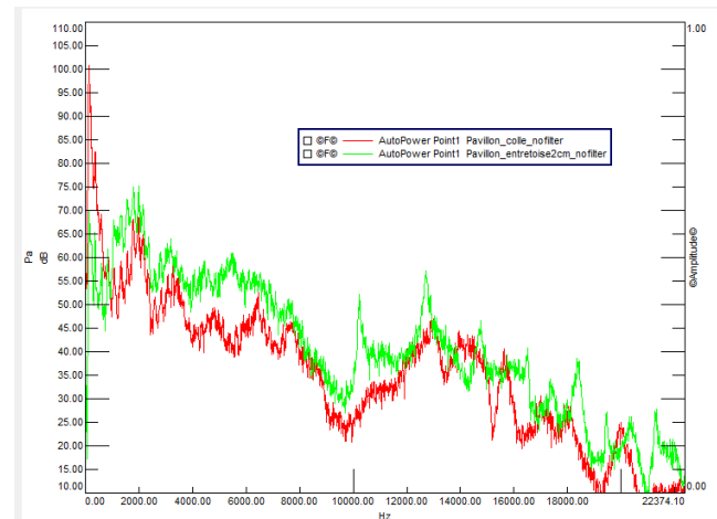
Figure 7: spectre d'émission du pavillon exponentiel collé (rouge) et décollé (vert)
