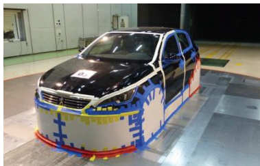
Figure 13 : Véhicule en soufflerie avec soubassement bloqué
