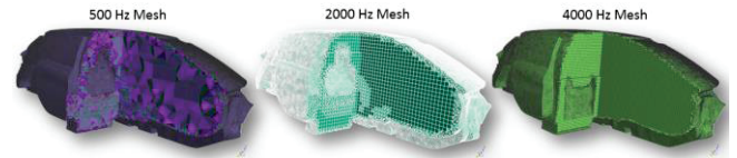
Figure 7: Maillages adaptatifs réalisés par le solveur ACTRAN
