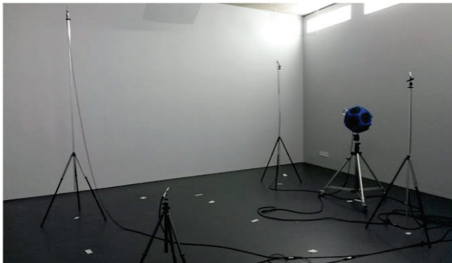
Abbildung 3: Nachhallzeit-Messung im Hallraum der Technischen Hochschule Ingolstadt
