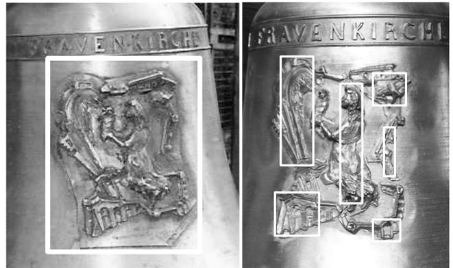
Abbildung 6: Wirksame Fläche im Vergleich: Glocke Hanna (f<sup>2</sup>) des ersten (links) und des zweiten Gusses (rechts)
