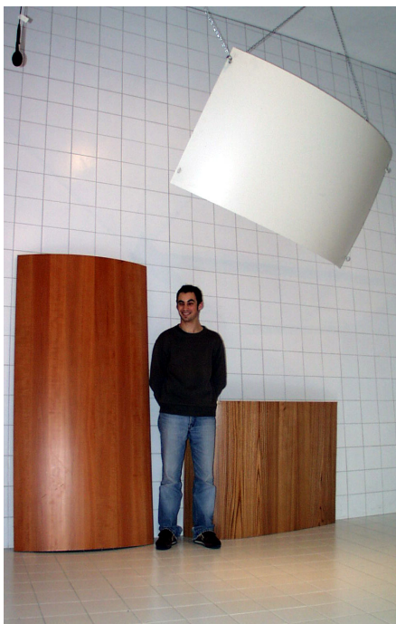
Figure 3. A gauche panneau pour absorption des graves ; à droite panneau réflecteur destiné à la partie des parois en avant de la scène. Cliché en salle réverbérante du LEMA.
