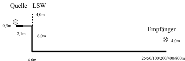
Abbildung 3: RQ12, naher Fahrstreifen, 6m Hochlage
