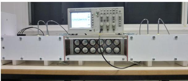
FIGURE 1 – Conduit acoustique équipé d'une paroi active.
