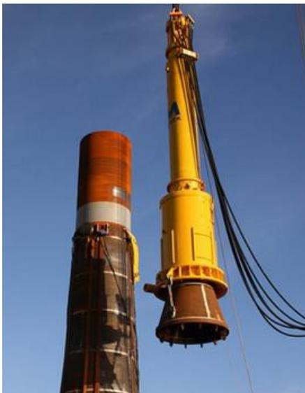
Figure 1: Marteau hydraulique à côté d'un pieu (<http://www.offshore-technology.com/contractors/dredging/menck/>).
