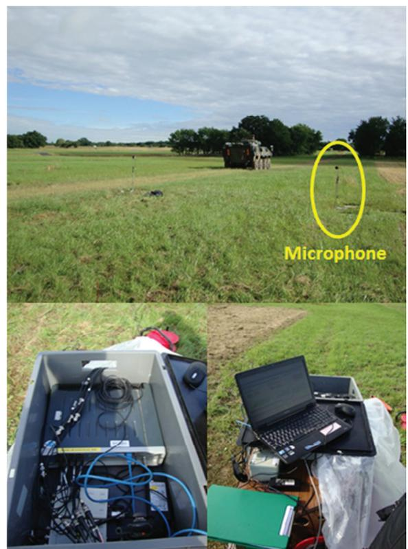
Figure 11 : Acquisition de signatures acoustiques d'un véhicule en roulage
