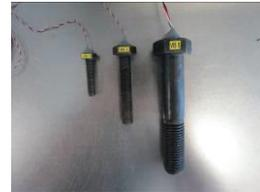
Figure 2- Vis instrumentées utilisées pour les assemblages
