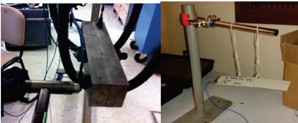
Figure 4 - Assemblage expérimental pour les liaisons de type 'carter de transmission' (gauche) et 'matériel frigorifique' (droite)
