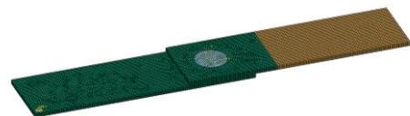
Figure 13- Modélisation des éprouvettes de type 'matériel frigorifique'. Maillage.
