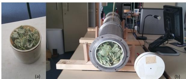
FIGURE 2 – Porte échantillon de 16 cm contenant le fusain (a), puis introduction dans le tube (b)
