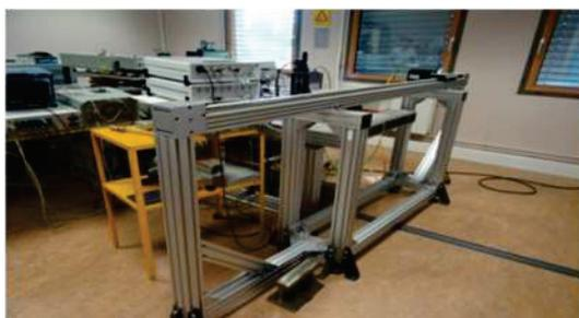
Figure 20 : Banc de guidage linéaire pour les essais Ultrasons-Laser
