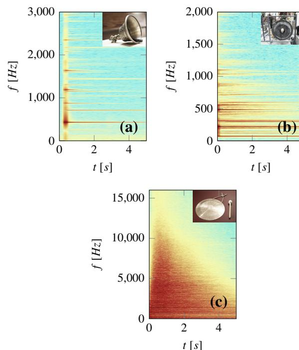
FIGURE 1 – Spectrogrammes des sons émis par des instruments idiophones typiques. (a) : cas d'une cloche,  $w \ll h$ , régime linéaire. (b) : cas d'un gong épais,  $w \sim h$ , régime faiblement non-linéaire montrant des phénomènes de couplage et des glissements de fréquence. (c) : cas d'un gong mince,  $w > h$ , création d'une cascade d'énergie vers les hautes fréquences.
