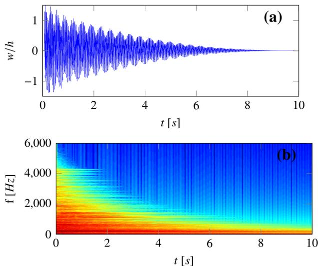
FIGURE 5 – Exemple de vibrations faiblement non-linéaires. (a) série temporelle du déplacement ; (b) spectrogramme de vitesse.
