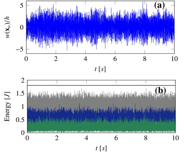
FIGURE 4 – Simulation temporelle d'une plaque d'acier de dimensions  $L_x \times L_y = 0.4 \times 0.6\text{m}^2$  et épaisseur  $h = 1.5\text{mm}$ . La simulation à été effectuée à l'aide du schema conservatif et la plaque ne present pas de perte. (a) Série temporelle du déplacement ; (b) énergie totale (ligne épaisse noire), énergie cinétique (gris), énergie potentielle linéaire (bleu), énergie potentielle non-linéaire (vert).
