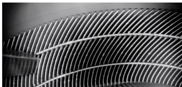
FIGURE 7 – Positionnement du capteur entre deux plaques de l'élément combustible.
