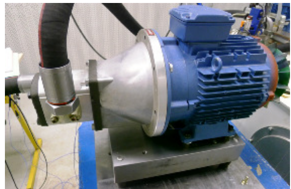
Figure 3: La source installée sur le récepteur étalon.
