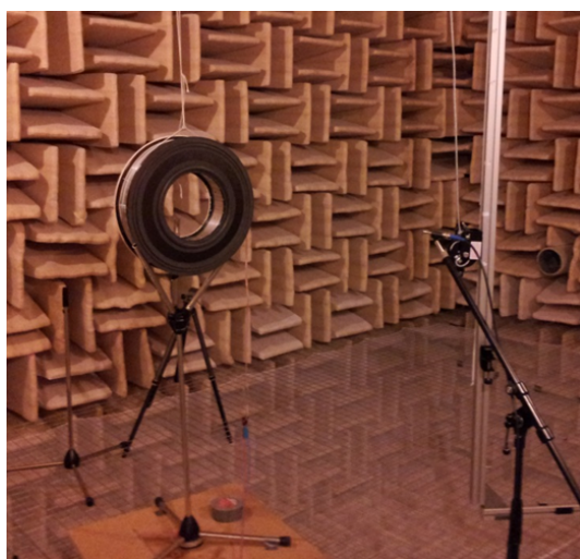
FIGURE 4 – Prototype de haut-parleur torique.
