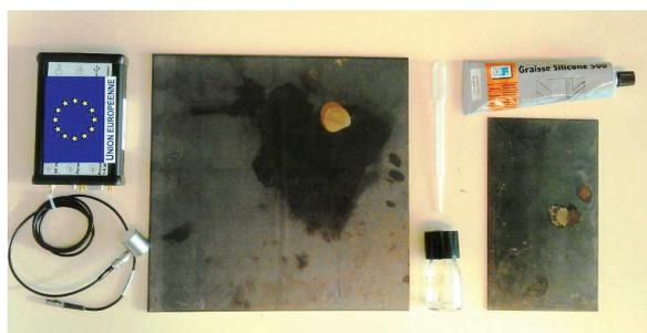
FIG. 4 – Matériel expérimental : les deux plaques d'acier, les transducteurs, le flacon d'acide ainsi que la graisse de silicone utilisée pour le couplage des transducteurs à la plaque.
