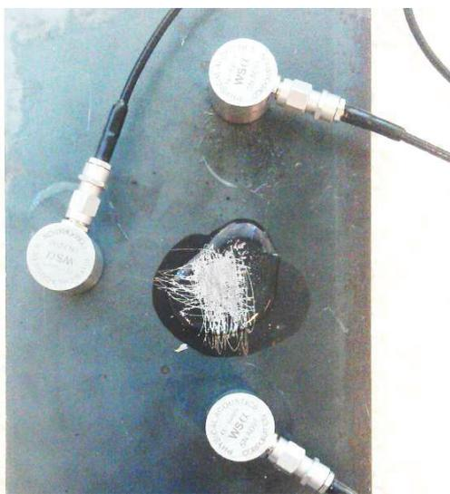
FIG. 5 – Expérience : plaque d'acier et capteurs d'EA utilisés pour la caractérisation de la corrosion. On distingue la zone abrasée sur laquelle a été déposée un film de solution acide.
