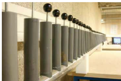
FIGURE 1 – Guide avec un réseau de résonateurs de Helmholtz
