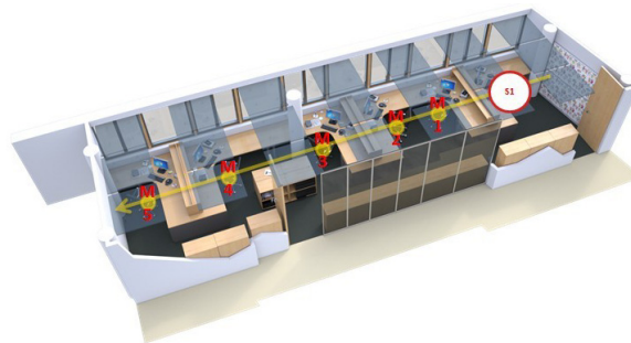
Illustration 2: Cheminement "a": Source en S1 (poste de travail situé à droite), chemin de mesure de droite à gauche.
