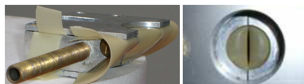
FIGURE 1b – Gauche : vue latérale de la maquette à profil triangulaire en cours d'assemblage (une seule corde vocale montrée). Droite : maquette assemblée avec pression d'eau établie.
