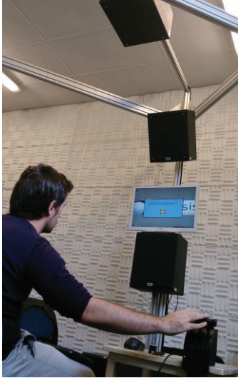
Figure 2: Dispositif pour l'expérience psychoacoustique menée dans le studio de simulation d'environnements sonores 3D du laboratoire d'acoustique d'AIRBUS à Toulouse (département des essais en vol).
