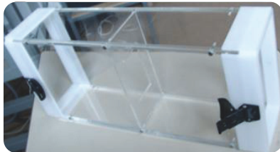
Figure 10: Tronçon support avec un diaphragme.
