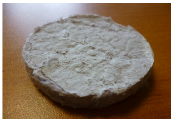
Figure 7 : Echantillon de l'isolant hautes températures à base d'aérogel.
