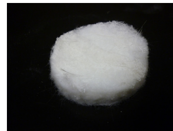
Figure 5 : Échantillon de l'isolant cryogénique à base d'aérogel.
