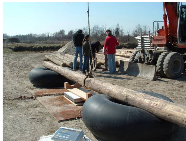
Figure 10 : Mesure du MOE dynamique sur poteaux.
