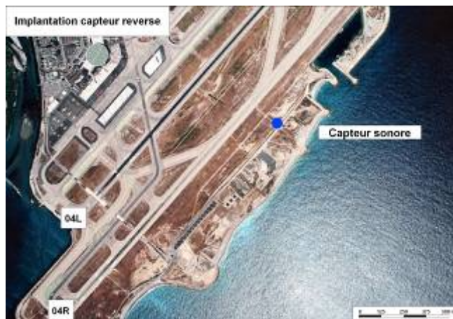
Figure 6 : emplacement du capteur sonore sur Nice Côte d'Azur pour la détection acoustique des inverseurs de flux en atterrissage.
