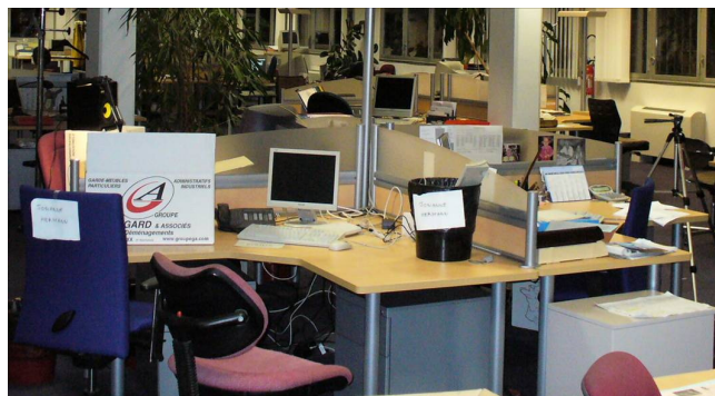
Figure 4 : écrans sur mobilier sans efficacité acoustique
