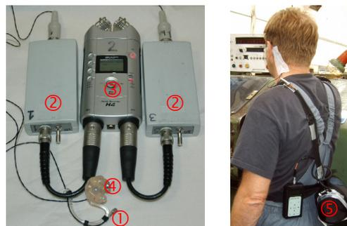
Figure 2 : Chaîne d'acquisition et équipement des sujets d'essai
