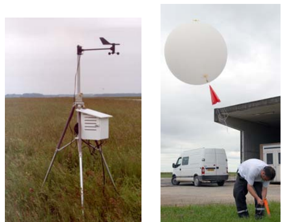
Figure 4 : Station météorologique au sol complétée par le lâcher d'un ballon sonde
