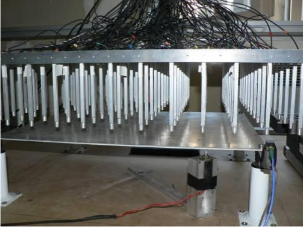
FIG. 1: Dispositif d'holographie en champ proche classique
