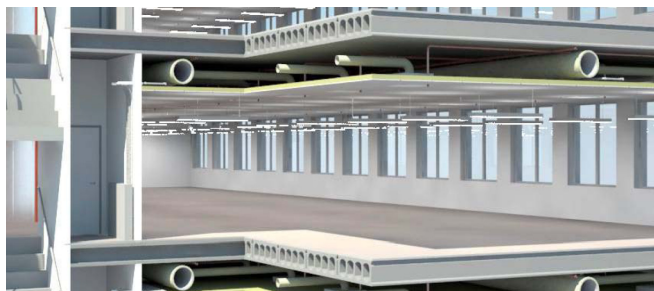
Figure 1 : écorché d'un plateau à aménager, délimité par les façades du bâtiment, le sol, le plafond suspendu intégrant l'éclairage.
