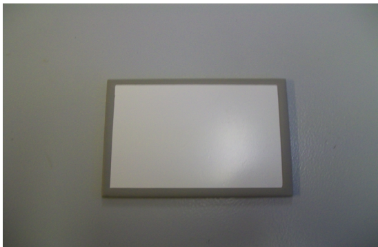
Figure 3: Deuxième échantillon : revêtement de peinture sur dural
