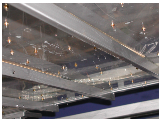
Figure 7 : Décrochement des gouttes en présence de buses individuelles (photo source VELUX)
