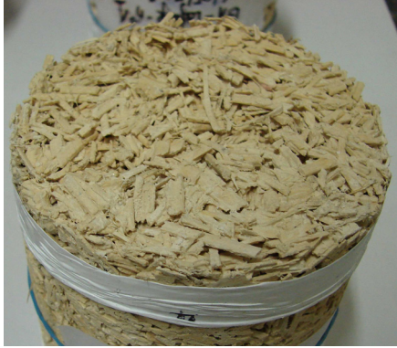
FIGURE 3 – Un exemple de béton de chanvre réalisé à partir d'une chaux hydraulique - Diamètre 10 cm
