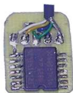
FIGURE 1 – Capteur MEMS (7 x 10 mm).
